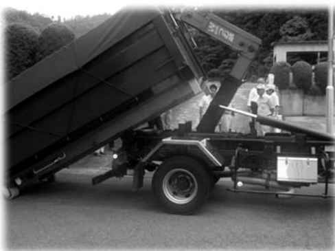
【汚泥をホッパーにて運搬】
